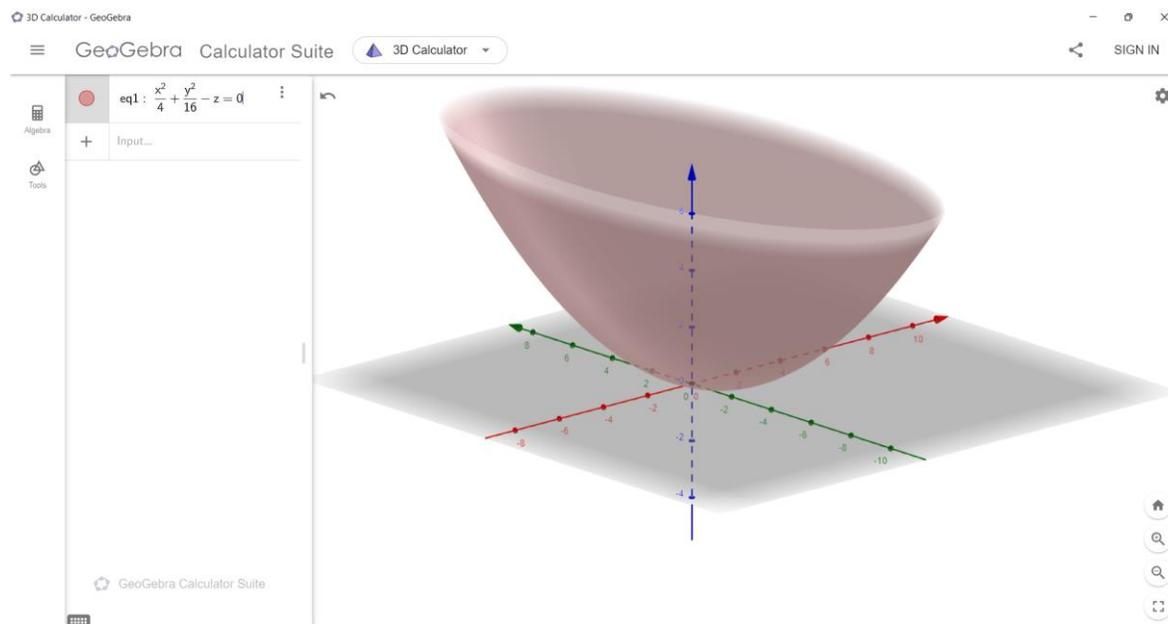
Si además es  $a = b$ , el paraboloides elíptico será un paraboloides de revolución, que es la superficie resultante de girar una parábola en torno a su eje de simetría.
